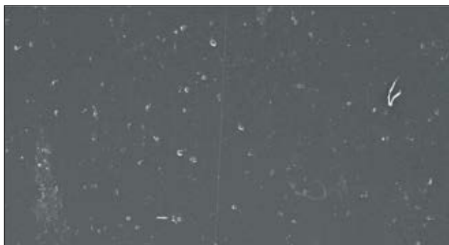
UV-sevanje je v spoju povzročilo poškodbe le v posameznih točkah.
