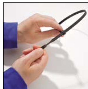
2. Povlecite trakec skozi glavo, dokler snop ni trdno povezan.
