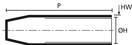
b: Formă complet recuperată (după încălzire)
