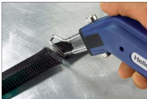
A HSG0 hővágó megakadályozza, hogy a kábelharisnya elkopjon.
