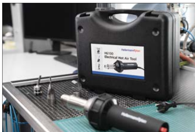
Das H6100 wird in einem Gerätekofter inkl. verschiedener Düsen geliefert.
