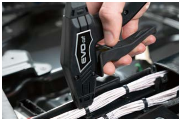
Der Kabelbinder kann an beliebiger Stelle durchtrennt werden.
