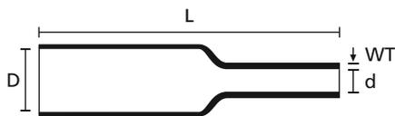
Schrumpfschlauch, Schrumpfrate: 3:1
