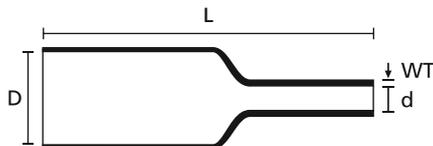
Schrumpfschlauch, Schrumpfrate: 4:1
