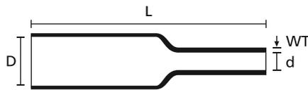
Schrumpfschlauch, Schrumpfrate: 3:1
