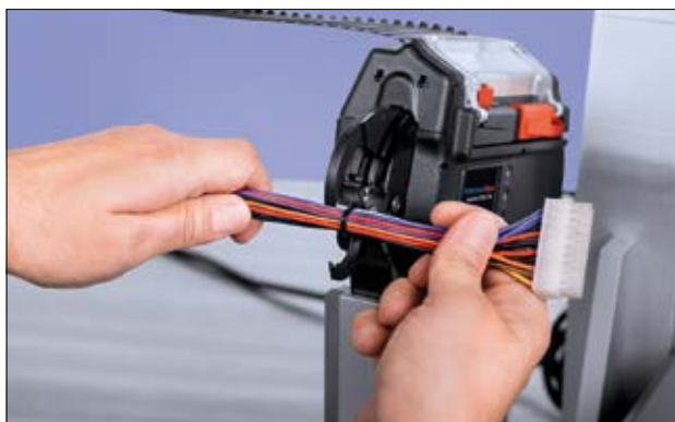
Anwendungsbeispiel: Kabelbaumbündelung in der Montagevorrichtung CPK.
