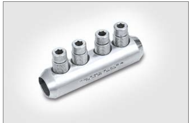
Verzinnte Schraubverbinder mit Trennsteg und Abreischrauben fr Al- und Cu-Leiter.
