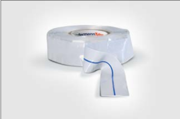
HelaTape Power 800 je trak trikotnega preseka iz silikonske gume.
