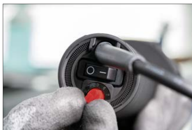
Reglarea temperaturii de funcționare H6100.
