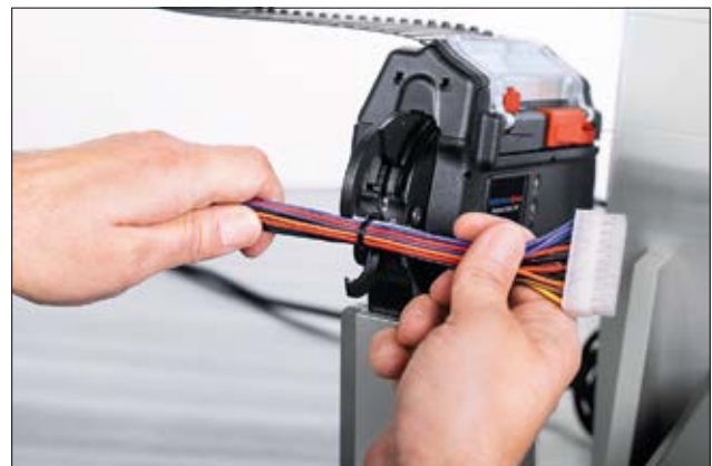
Aplicare cu kitul de montare la stația de lucru CPK.
