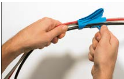
Inserați unul sau mai multe cabluri în slotul de inserție al instrumentului de aplicare HAT.
