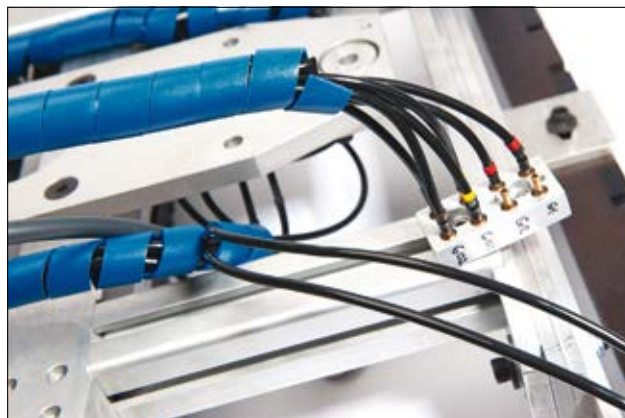
Detekovatelné, spirálové oplety s obsahem kovu chrání kabely na potravinářských strojích.
