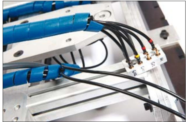
Detektierbare, metallhaltige Spiralschläuche schützen Kabel an Lebensmittelverarbeitungsmaschinen.
