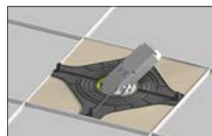
3. Einsetzen des Einbaustrahlers durch die zugeschnittene Montageöffnung.
