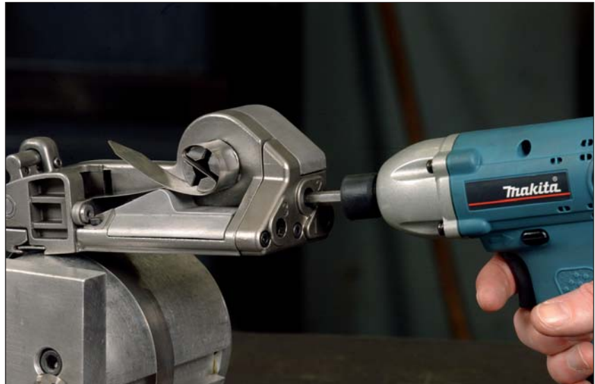
Das AMTS ist einfach zu bedienen und beschleunigt die Verarbeitung von Metallkabelbindern.
